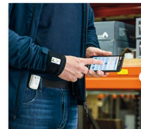
Die Mitarbeiter tragen mobile Sensoren am Handgelenk und am Gürtel. Ein Mobile Device speichert dann mit Hilfe der an den Lagerregalen angebrachten Beacons die Daten und die Position im Lager.
